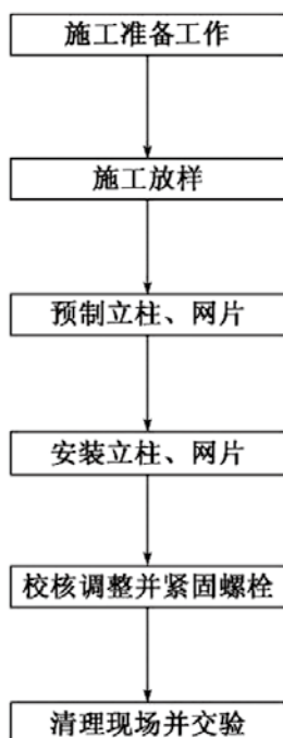
图 1.3.18 防眩网的施工工艺流程图
